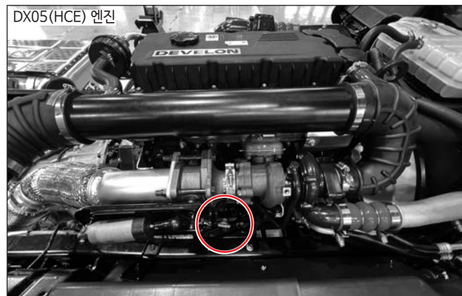
1) DX05(HCE) 엔진 캡을 올리면 엔진 오른쪽(조수석 쪽) 하단부에 게이지가 있습니다.
