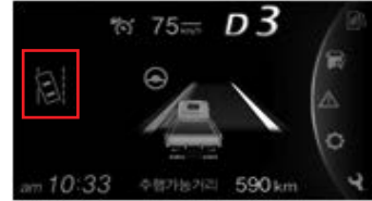
4.3인치 컬러 LCD 디스플레이 장치
